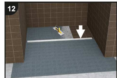
12 Rimessa della protezione in polistirolo, stesura della colla cementizio e posa delle piastrelle. Place another time polystyrene protection and spreading adhesive cement for tiles installation.
